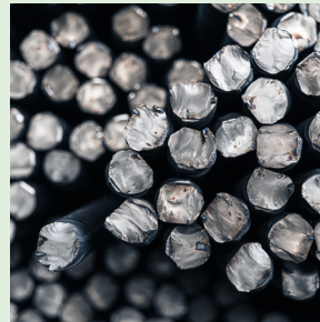
Betonstahl in Stäben
