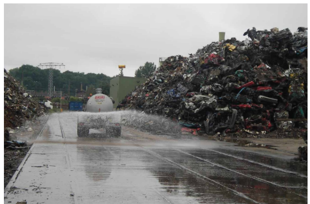
Regelmäßige mobile Befeuchtung der Straßen (Bereich Schrottplatz)
