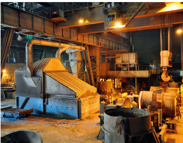
Installierte Absaughaube über der Pfanenschlackebox (links) sowie Schlackenmanagement E-Ofenschlacke in der Stahlwerkshalle (rechts)
