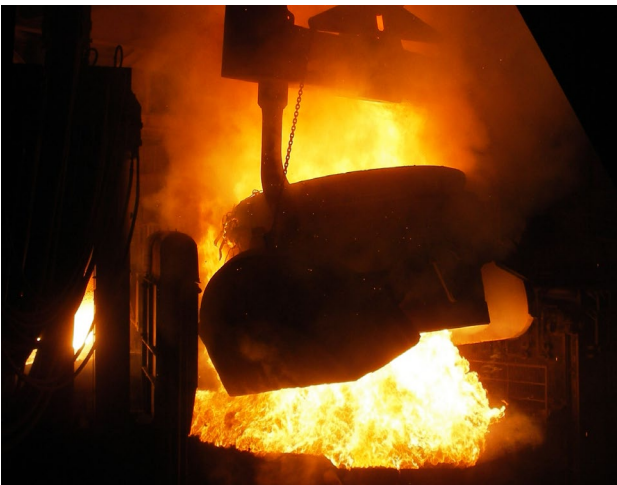
E-Ofen in Betrieb, dargestellt sind das Chargieren (links) sowie das Einschmelzen (rechts)
