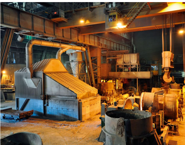
Installierte Absaughaube über der Pfannenschlackebox (links) sowie Schlackenmanagement E-Ofenschlacke in der Stahlwerkshalle (rechts)
