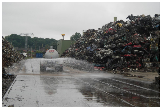
Regelmäßige mobile Befeuchtung der Straßen (Bereich Schrottplatz)
