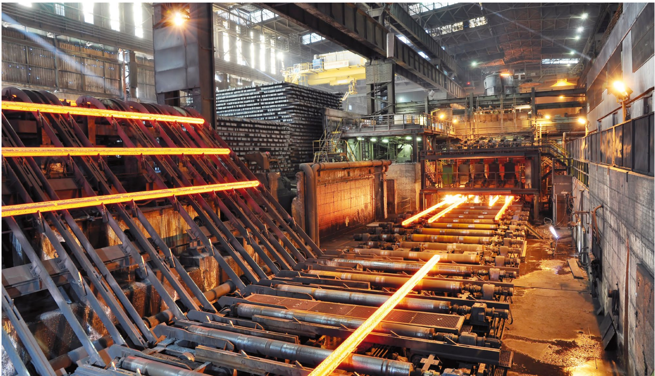
Stranggussanlage in Betrieb, Erzeugung von Knüppeln
