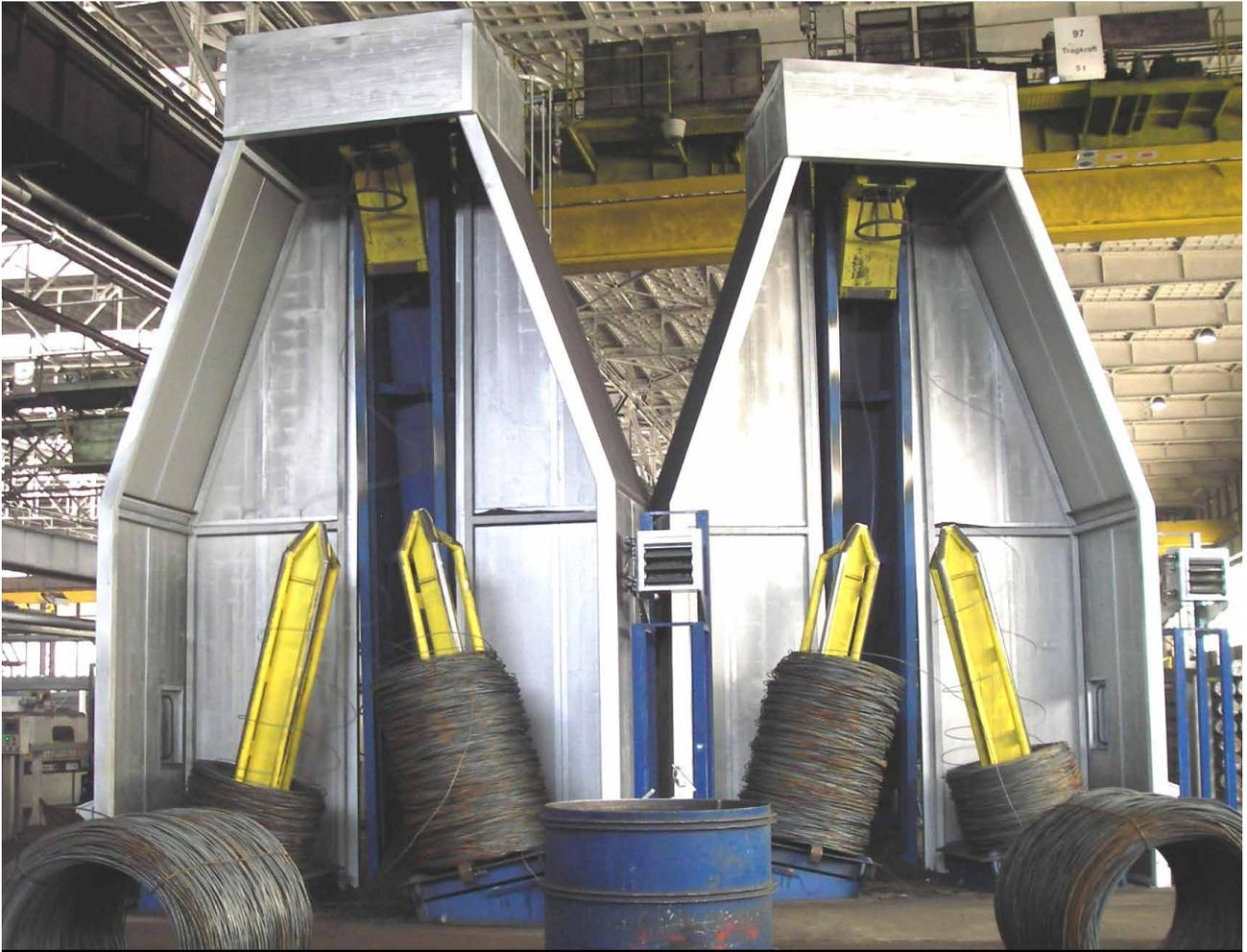
Walzdrahtablauf der TEUREMA-Reckanlagen mit realisierten Schallschutzmaßnahmen
