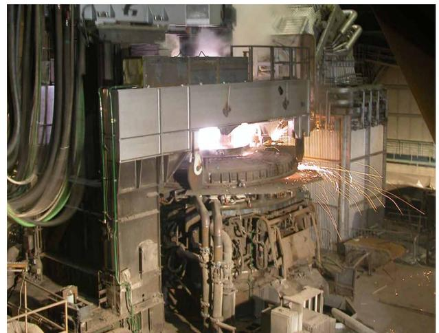
E-Ofen in Betrieb, dargestellt sind das Chargieren (links) sowie das Einschmelzen (rechts)
