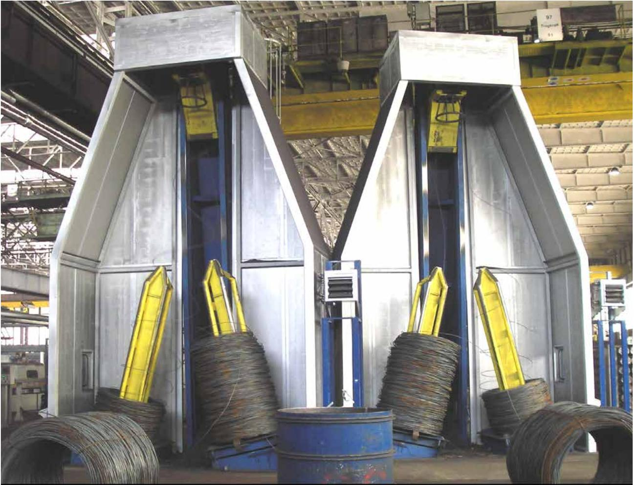
Walzdrahtablauf der TEUREMA-Reckanlagen mit realisierten Schallschutzmaßnahmen
