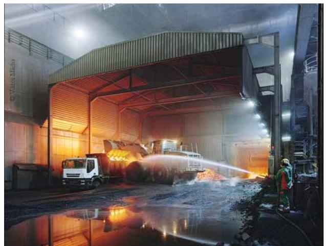
Installierte Absaughaube über der Pfannenschlackebox (links) sowie Schlackenmanagement E-Ofenschlacke in der Stahlwerkshalle (rechts)
